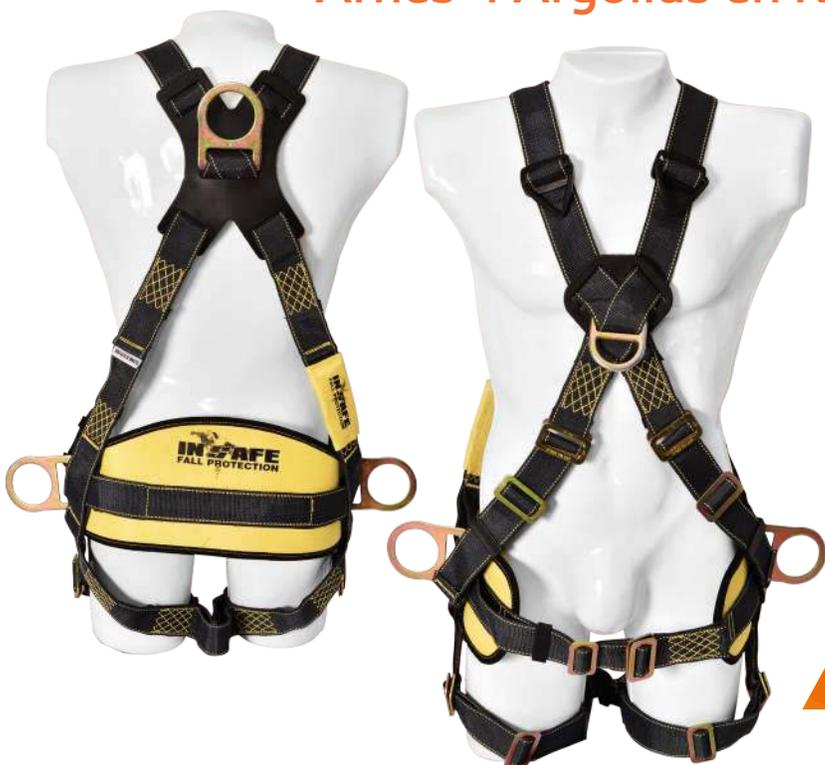
Arnés de cuerpo entero en reata **NOMEX/KEVLAR** cumpliendo la norma **ASTM F887-13**, especial para trabajos de **SOLDADURA**, posee 1 argolla dorsal en "D" para la detención y restricción de caídas, 2 argollas laterales en "D" para posicionamiento a un punto fijo, 1 argolla frontal en "D" para ascenso y descenso controlado. Con soporte lumbar ergonómico. **(ENERGÍA INCIDENTE EI, 46 CAL/CM2)**
