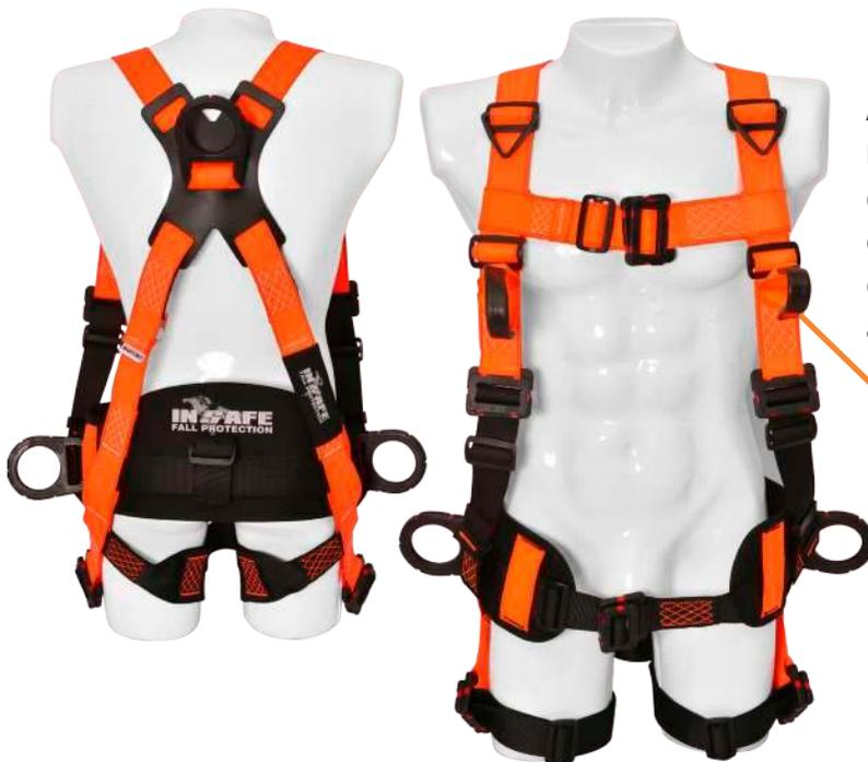
Arnés de cuerpo entero en reata poliéster **DIELÉCTRICO**, posee 1 argolla dorsal en "D" para la detención y restricción de caídas, 2 argollas laterales en "D" para posicionamiento a un punto fijo, 2 anillos en reata frontal en "D" como punto de anclaje para ascenso y descenso controlado, soporte lumbar con diseño ergonómico.
