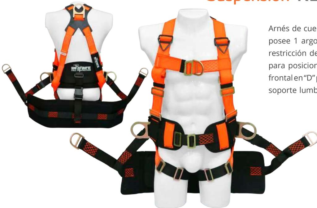
Arnés de cuerpo entero en reata poliéster en H, posee 1 argolla dorsal en "D" para detención y restricción de caídas, 2 argollas laterales en "D" para posicionamiento a un punto fijo, 1 argolla frontal en "D" para ascenso y descenso controlado, soporte lumbar con diseño ergonómico y **SILLA DE SUSPENSIÓN INCORPORADA**.
