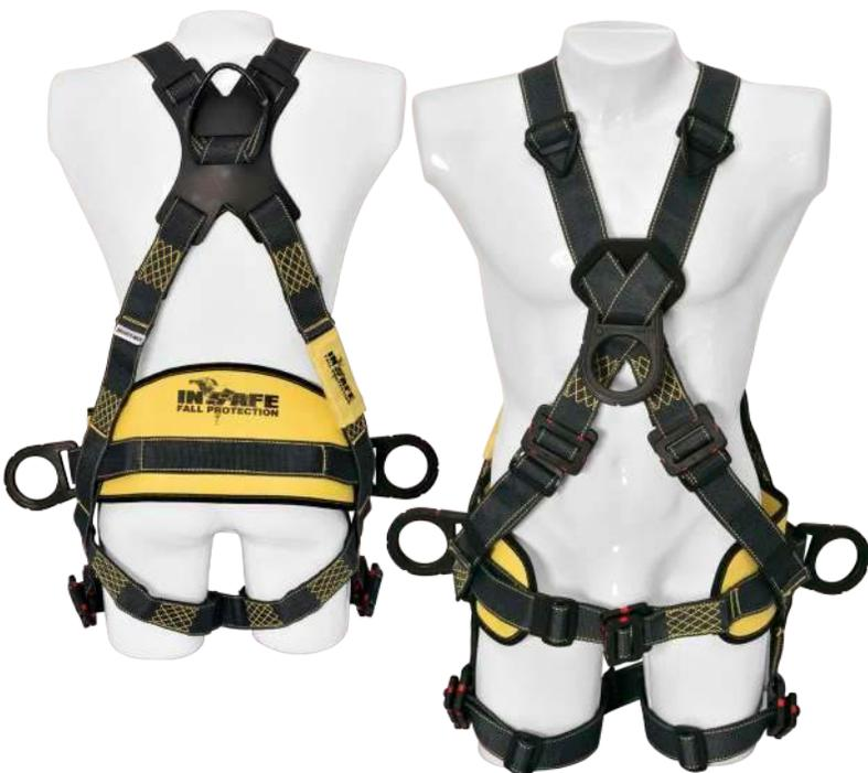
Arnés de cuerpo entero en reata **NOMEX/KEVLAR** cumpliendo la norma **ASTM F887-13**, posee 1 **ARGOLLA EN REATA DORSAL** en "D" para la detención y restricción de caídas, 2 argollas laterales en "D" para posicionamiento a un punto fijo, 1 argolla frontal en "D" para ascenso y descenso controlado. Soporte lumbar con diseño ergonómico. **(ENERGÍA INCIDENTE EI, 46 CAL/CM2).**
