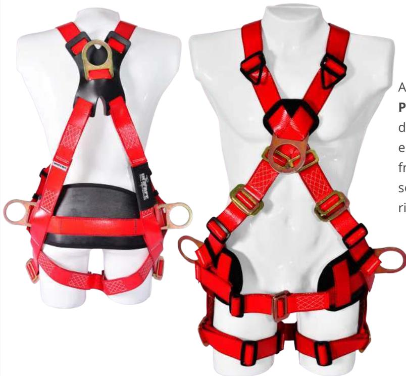
Arnés de cuerpo entero en reata con recubrimiento en **POLIURETANO**, posee 1 argolla dorsal en "D" para la detención y restricción de caídas, 2 argollas laterales en "D" para posicionamiento a un punto fijo, 1 argolla frontal en "D" para ascenso y descenso controlado, soporte lumbar con diseño ergonómico minimizando el riesgo en las malas posturas del usuario
