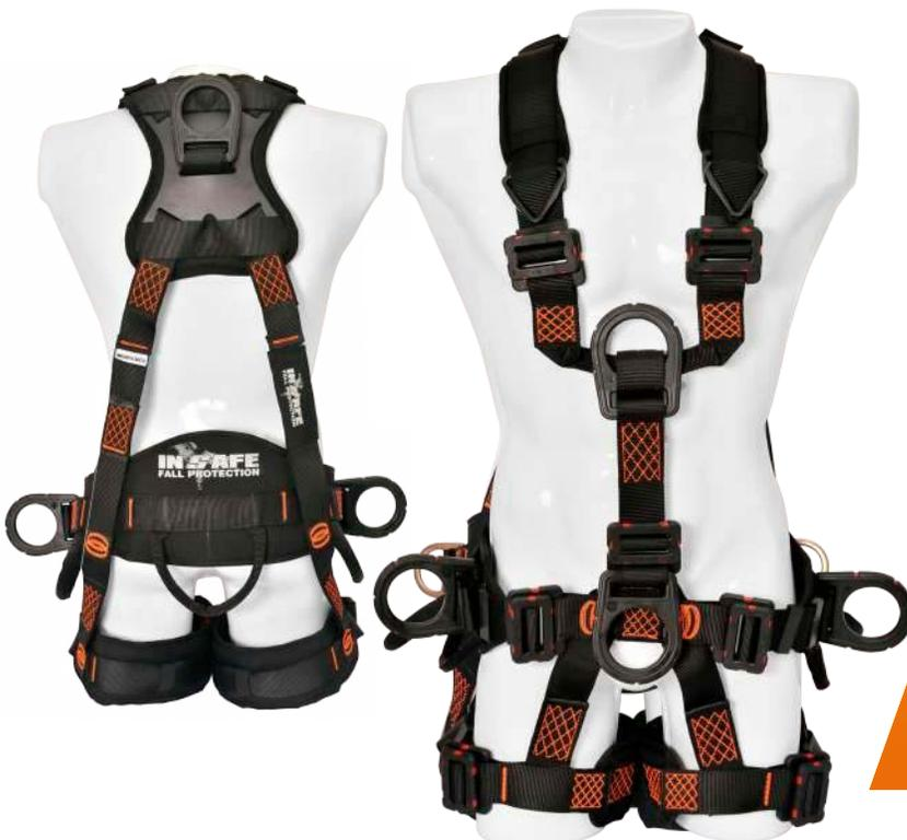
Arnés de cuerpo entero en reata poliéster para Rescate, **DIELÉCTRICO**, estilo en U, posee 1 argolla dorsal en "D" para la detención y restricción de caídas, 2 argollas laterales en "D" para posicionamiento a un punto fijo, 1 argolla frontal en "D" para ascenso y descenso controlado, 1 argolla en "D" pélvica para rescate, soporte lumbar con diseño ergonómico.
