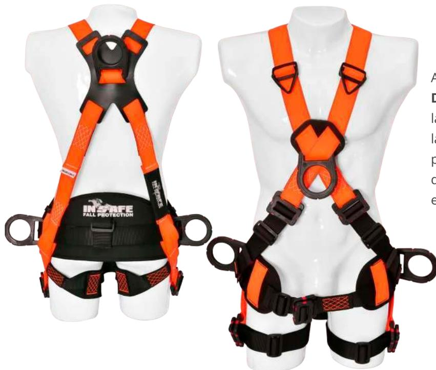
Arnés de cuerpo entero en reata poliéster, **DIeléCTRICO**, posee 1 argolla dorsal en "D" para la detención y restricción de caídas, 2 argollas laterales en "D" para posicionamiento a un punto fijo, 1 argolla frontal en "D" para ascenso y descenso controlado, soporte lumbar con diseño ergonómico.
