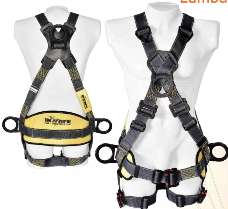
Arnés de cuerpo entero en reata **NOMEX/KEVLAR** cumpliendo la norma **ASTM F887-13, PARA ARCO ELÉCTRICO**, posee 1 argolla dorsal en "D" para la detención y restricción de caídas, 2 argollas laterales en "D" para posicionamiento a un punto fijo, 1 argolla frontal en "D" para ascenso y descenso controlado, soporte lumbar con diseño ergonómico (**ENERGÍA INCIDENTE EI, 46 CAL/CM2**).
