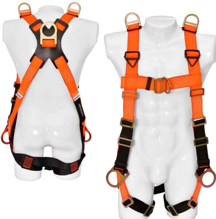
Arnés de cuerpo entero en reata poliéster en H, **6 ARGOLLAS**, posee 1 argolla dorsal en "D" para la detención y restricción de caídas, 2 argollas laterales en "D" para posicionamiento a un punto fijo, 1 argolla frontal en "D" para ascenso y descenso controlado, 2 argollas en "D" sobre los hombros para operaciones espacios confinados.
