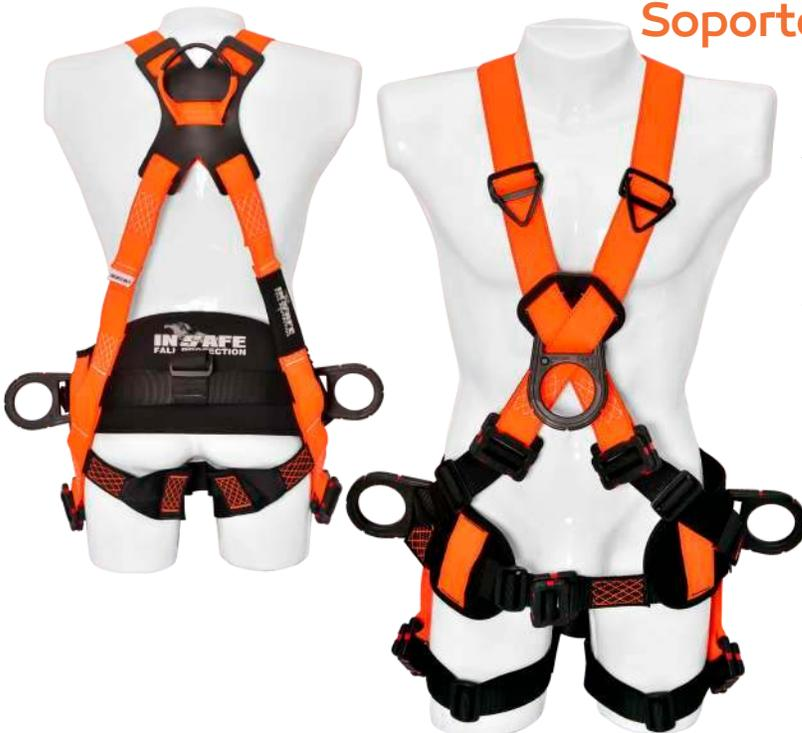
Arnés de cuerpo entero en reata poliéster, **DIELÉCTRICO**, posee 1 **ARGOLLA DORSAL EN REATA** en "D" para detención y restricción de caídas, 2 argollas laterales en "D" para posicionamiento a un punto fijo, 1 argolla frontal en "D" para ascenso y descenso controlado, soporte lumbar con diseño ergonómico.
