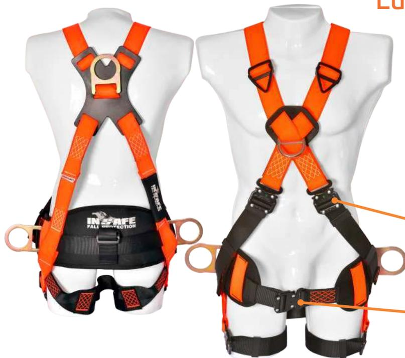
Arnés de cuerpo entero en reata poliéster, posee 1 argolla dorsal en "D" para la detención y restricción de caídas, 2 argollas laterales en "D" para posicionamiento a un punto fijo, 1 argolla frontal en "D" para ascenso y descenso controlado, soporte lumbar con diseño ergonómico y **Hebillas de ajuste rápido** que hace más simple y sencillo el ajuste.
