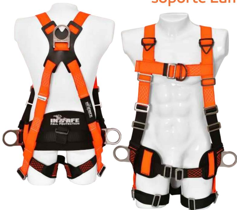
Arnés de cuerpo entero en reata poliéster, posee 1 argolla dorsal en "D" para la detención y restricción de caídas, 2 argollas laterales en "D" para posicionamiento a un punto fijo, 1 argolla frontal en "D" para ascenso y descenso controlado, soporte lumbar con diseño ergonómico y **HERRAJERÍA EN ACERO INOXIDABLE** para evitar la corrosión.
