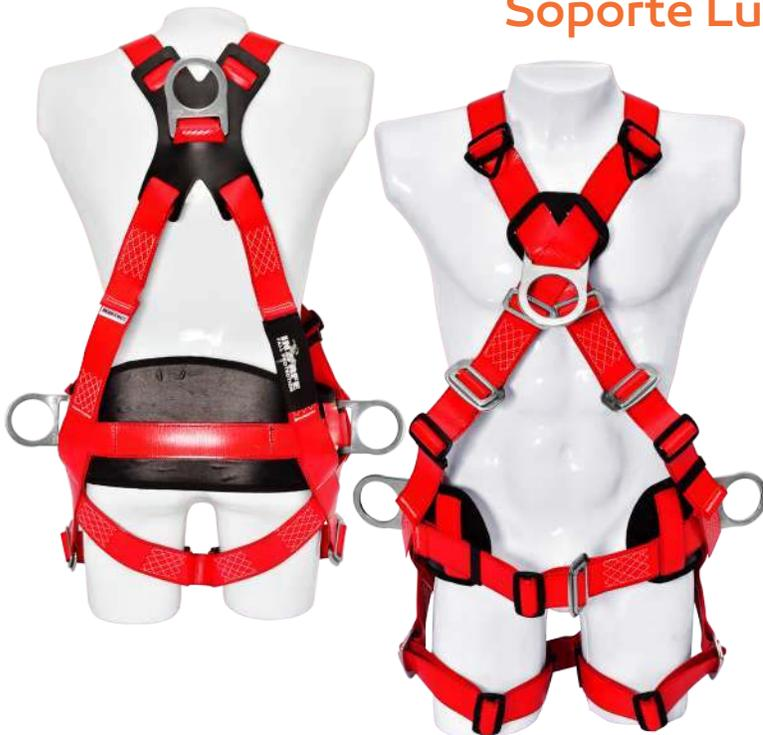
Arnés de cuerpo entero en reata con recubrimiento en **POLIURETANO** con herrajería en Acero Inoxidable para evitar la corrosión. Posee 1 argolla dorsal en "D" para la detención y restricción de caídas, 2 argollas laterales en "D" para posicionamiento a un punto fijo en, 1 argolla frontal en "D" para ascenso y descenso controlado, soporte lumbar con diseño ergonómico minimizando el riesgo en las malas posturas del usuario.
