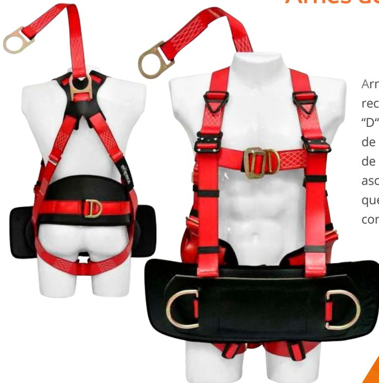
Arnés de cuerpo entero de encuellador en reata con recubrimiento en **POLIURETANO**, posee 1 argolla dorsal en "D" con **ESLINGA FIJA DE 45 CM** para conexión del sistema de detención de caídas (RETRÁCTIL), 1 argolla pectoral de "D" para realizar conexión segura en actividades de ascenso y descenso. **SOPORTE LUMBAR ACOLCHADO** que proporciona confort en largas jornadas de trabajo con argolla en "D" a nivel lumbar; cuenta con protector abdominal desmontable.
